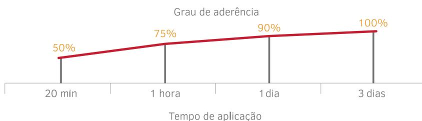
São disponibilizados dois tipos de adesivos, EA e EAA, sendo que os dois possuem alta qualidade e podem ser utilizados em ambientes externos e internos. Antes da aplicação do clip recomenda-se que a superfície seja limpa com álcool isopropílico.
