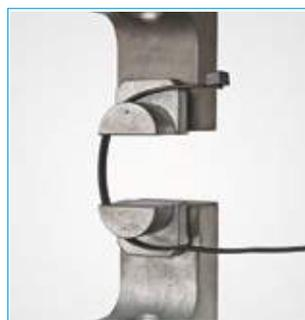
A carga na qual a abraçadeira se rompe é medida e gravada em software que disponibiliza os dados do ensaio em gráfico conforme o apresentado na próxima página.
