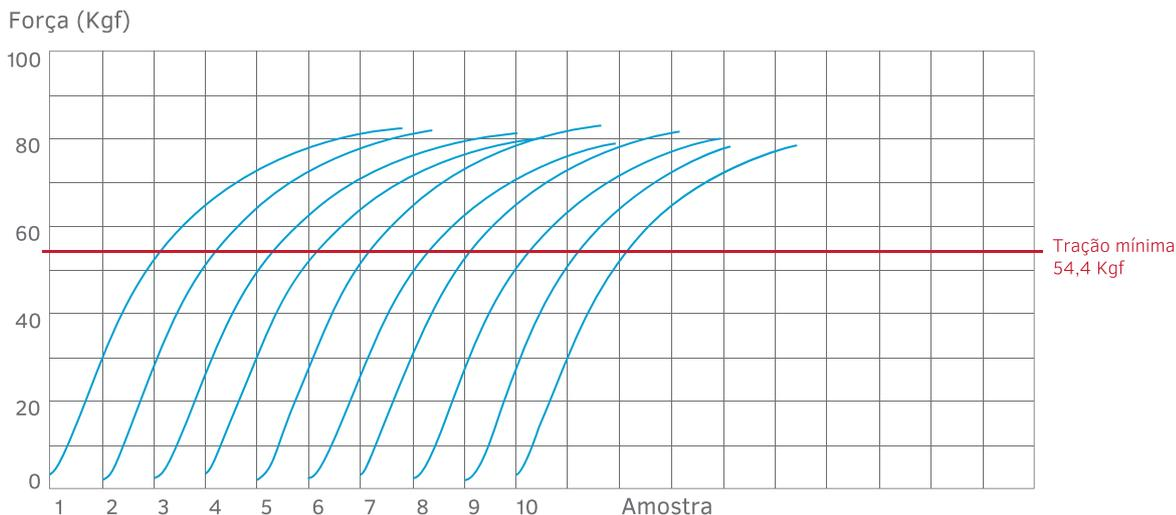
O gráfico acima representa o teste de resistência à tração realizado em 10 amostras da abraçadeira F7040. A tensão mínima de ruptura esperada é de 54,4 Kgf e o resultado apresentou valores próximos de 80 Kgf (o resultado foi 47% superior que o especificado no catálogo).
