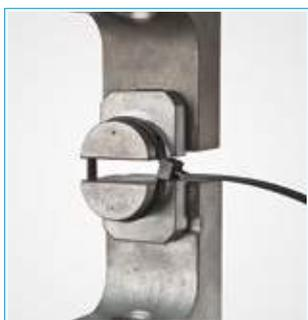
A abraçadeira é fixada em um mandril com diâmetro definido para cada modelo de abraçadeira.
